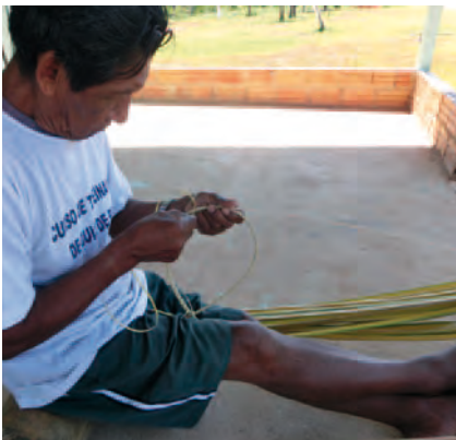
Abb. 5.2: Einbringen einer weiteren Rippe
